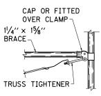
BRACE AND TRUSS CONNECTOR
