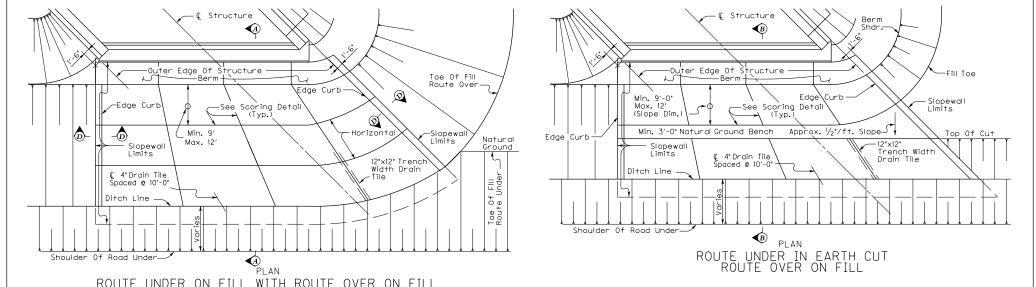
ROUTE UNDER ON FILL WITH ROUTE OVER ON FILL ROUTE UNDER AT GRADE WITH ROUTE OVER ON FILL
