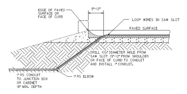
SAW SLOT EDGE OF PAVEMENT TRANSITION
