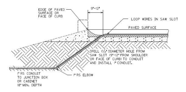
SAW SLOT EDGE OF PAVEMENT TRANSITION
