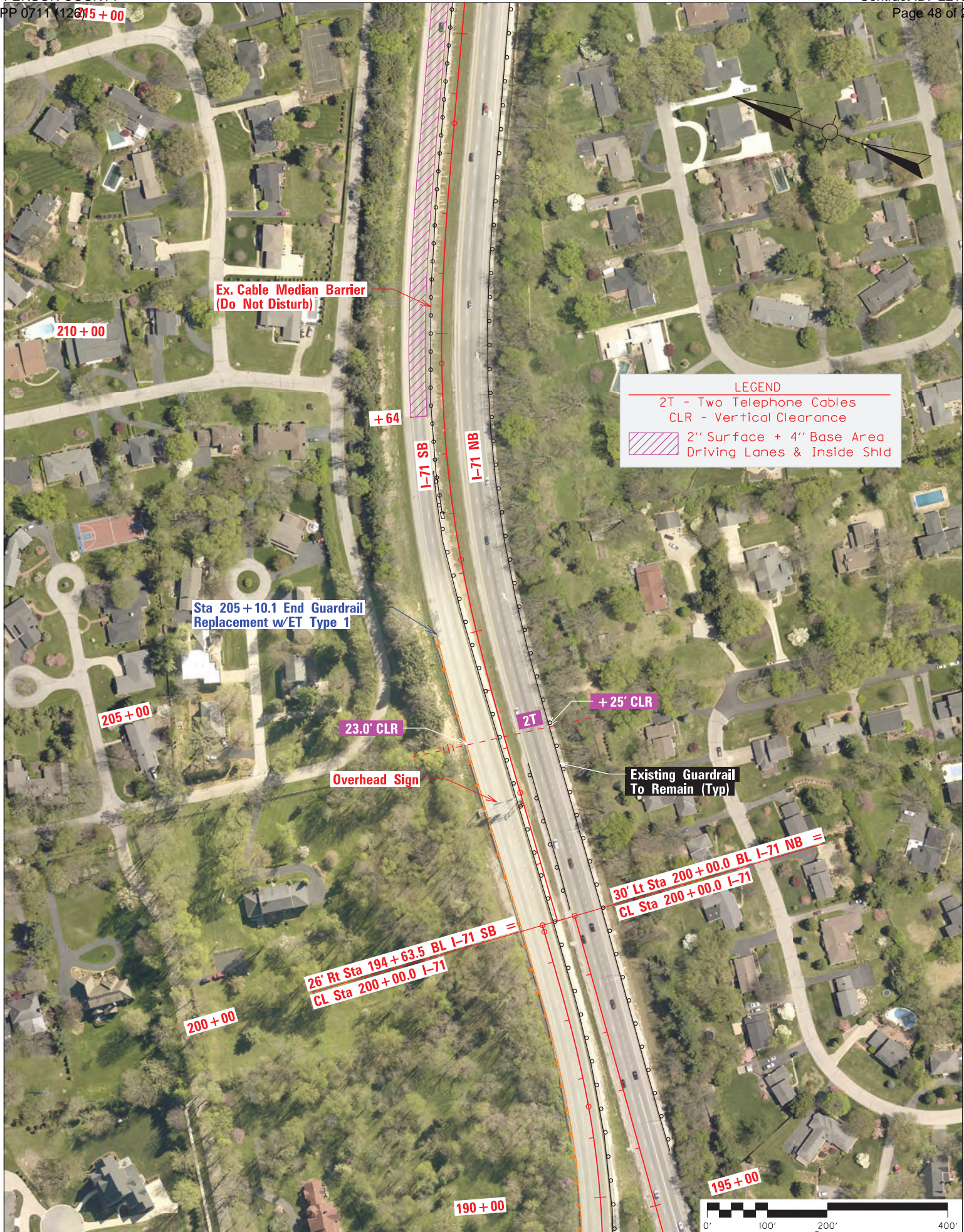
I-71 Rehab Plan - Scale 1" = 200' - Sheet 6 of 16 - Sta 195+00 to Sta 215+00
