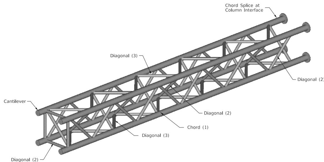
**ISOMETRIC VIEW OF CANTILEVER TRUSS ARM**
