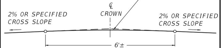
IN A HORIZONTAL CURVE, ROUNDING SHOULD BE USED AT HINGE POINT BETWEEN SUPERABLE AND NON-SUPERABLE SHOULDERS.
