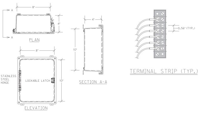
JUNCTION BOX/POST ASSEMBLY LOCATED BEHIND GUARDRAIL SHALL BE A MINIMUM OF 60" FROM THE FACE OF THE GUARDRAIL
