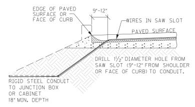
SAW SLOT EDGE OF PAVEMENT TRANSITION
